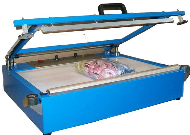
La saldatrice per sacchetti **GMT11** è una saldatrice da banco appositamente studiata per confezionare gomitoli, con una saldatura che consente di refillare l'eccedenza del sacchetto, ed un piano d'appoggio regolabile per poter eseguire la saldatura a metà dell'altezza del pacco.
